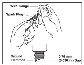
Figure 14. Servicing Spark Plug.
