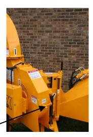
CUTTER DISK LOCK PIN IN LOCKED POSITION
