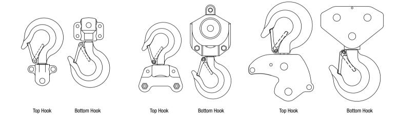
500kg, 1 & 2 tonne 3 & 5 tonne 10 tonne
