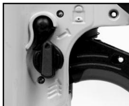
Mode de déclenchement séquentiel (sélecteur de mode de déclenchement pointant vers le haut)
